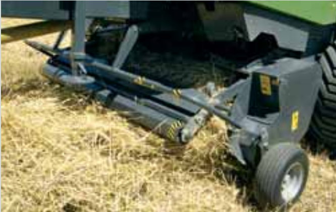
Die Fendt Rundballenpressen sind serienmäßig mit einer 2,20 m breiten Pick-up ausgestattet.
