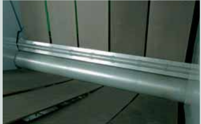
Zur Selbstreinigung der Riemenwalzen sind die variablen Fendt Rundballenpressen serienmäßig mit dem SCR-System (Selbst-Reinigungs-Rolle) ausgestattet.
