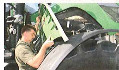
Um die Wartungsstellen am Motorblock besser erreichen zu können, lassen sich auch die Seitenteile abnehmen (o.).
