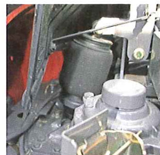
Der in der pneumatischen Kabinenfederung beinhaltenen Brems- und Nickausgleich verbessert den Komfort erheblich.
