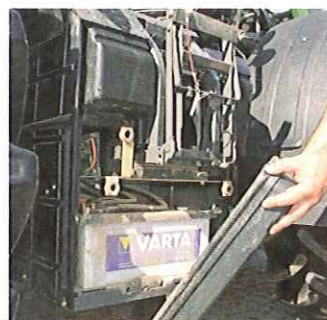
Wie bei den 900er Varios üblich, sitzt die Batterie unter dem Tank. Um daran zu kommen, muss die Leiter hochgeklappt werden.
