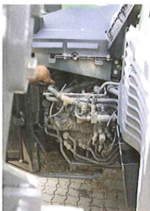
Auf den ersten Blick beeindruckt der riesige Oberlenker (l.), der eine sehr hohe Zugkraft bietet. Dahinter liegen die sechs elektrischen dw-Zusatzsteuergeräte. Sie sind als unter Druck kuppelbare Hebelkupplungen ausgelegt. Der Ventilblock (r.) befindet sich rechts unterhalb der Kabine.
