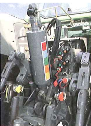
Auf den ersten Blick beeindruckt der riesige Oberlenker (l.), der eine sehr hohe Zugkraft bietet. Dahinter liegen die sechs elektrischen dw-Zusatzsteuergeräte. Sie sind als unter Druck kuppelbare Hebelkupplungen ausgelegt. Der Ventilblock (r.) befindet sich rechts unterhalb der Kabine.
