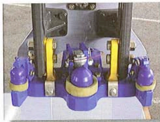
Zugkugelkupplung mit zwei Zwanglenkungs-Bauteilen (ein Bauteil links und ein Bauteil rechts)
