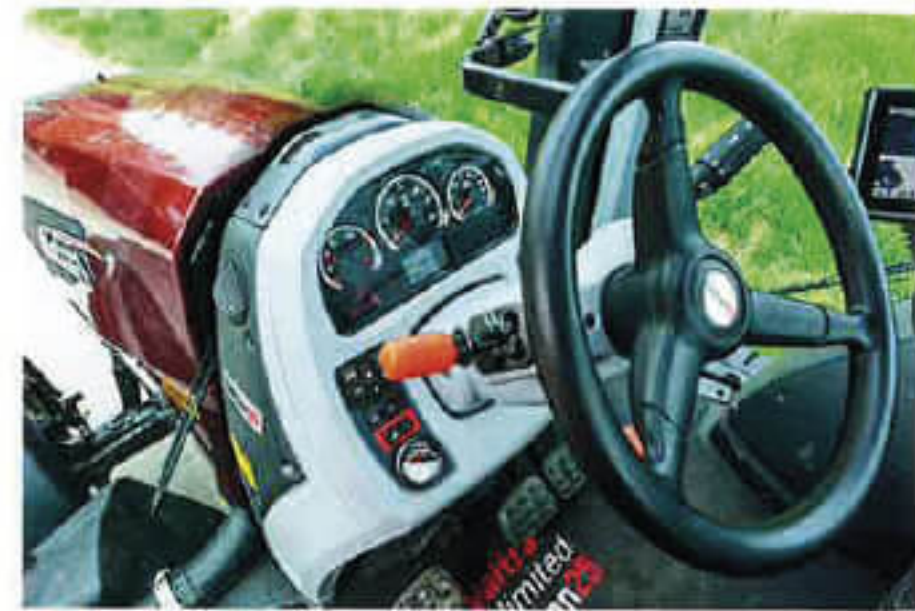
Das kleine Lenkrad kommt immer noch gut an. Der rastende Wendehebel „verträgt“ sich nicht mit der Wendeschaltung rechts.
