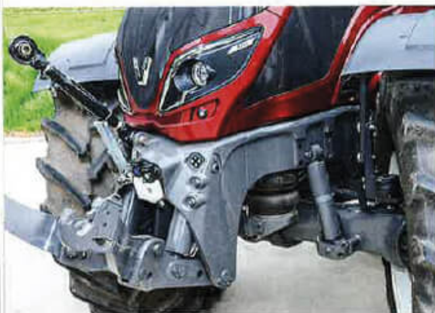
Die luftgefederte Vorderachse sorgt für exzellenten Fahrkomfort.
