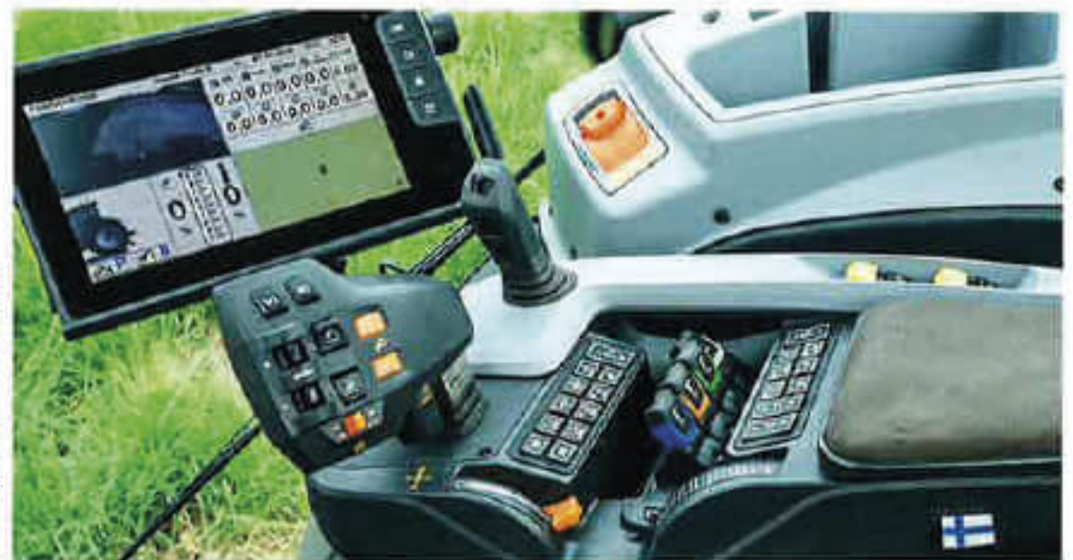
Das kleine Lenkrad kommt immer noch gut an. Der rastende Wendehebel „verträgt“ sich nicht mit der Wendeschaltung rechts.
