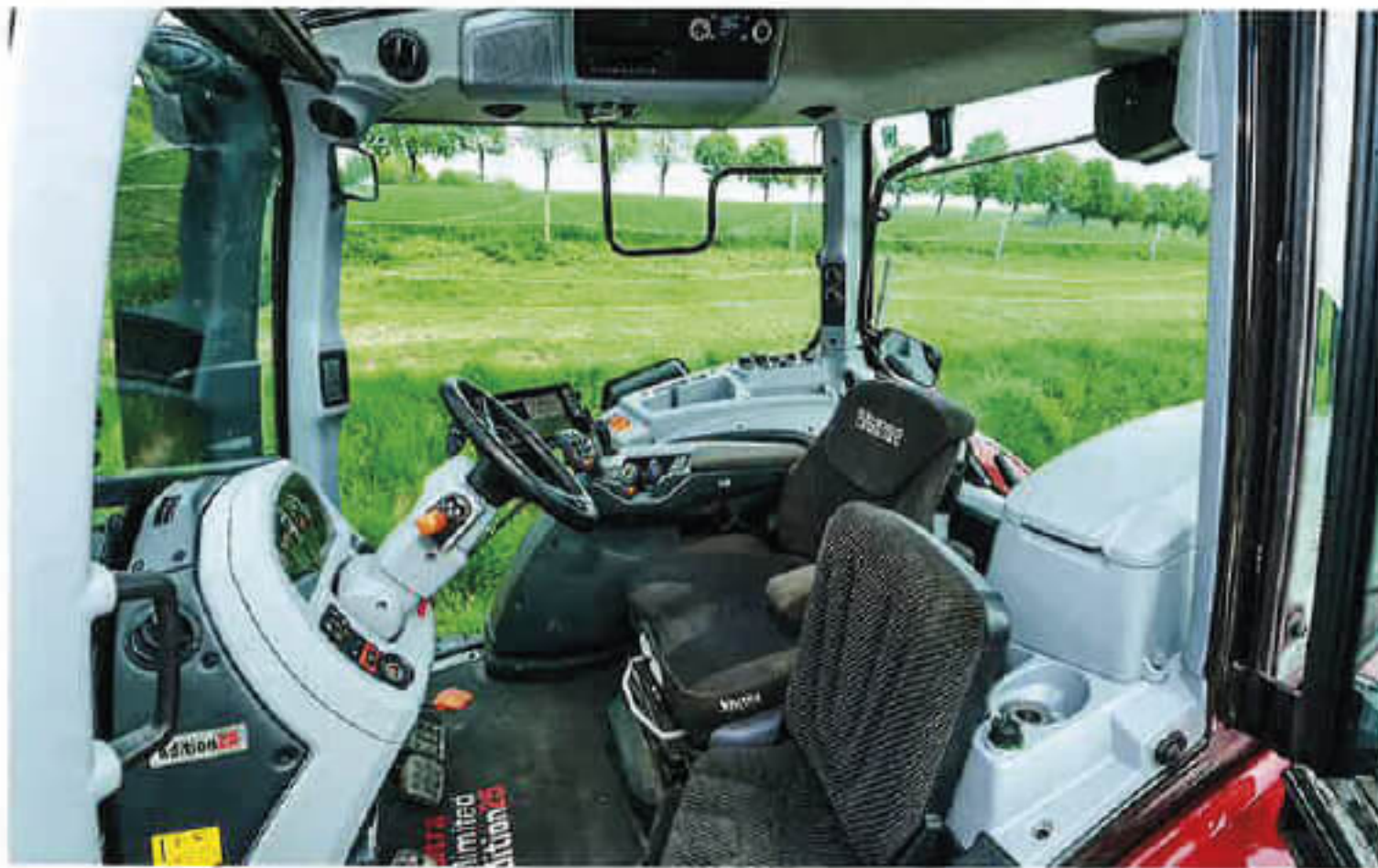
Groß, mit nur 72,1 dB(A) schön leise und mit einer super Rundumsicht: die Kabine der neuen T-Serie.
