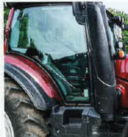
Sauber: der optionale Seitenwischer rechts
