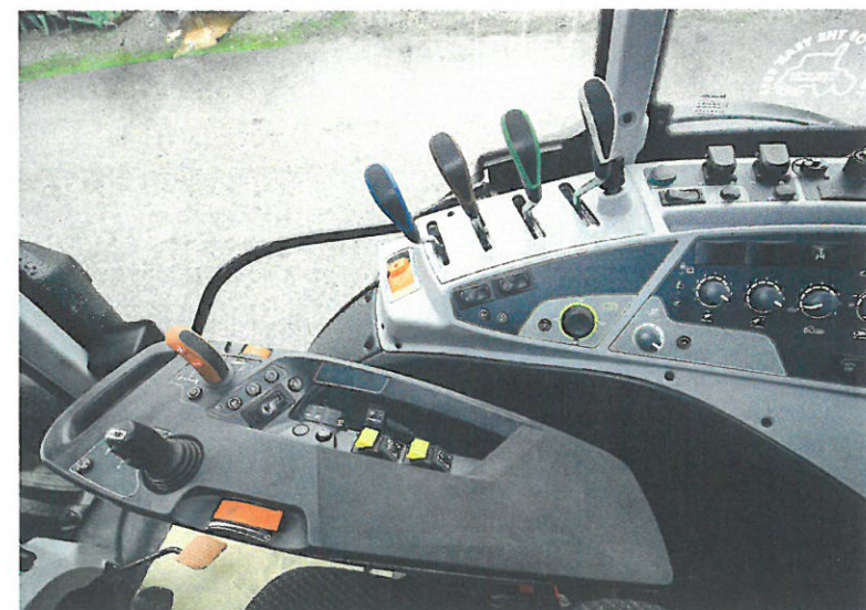
Auf der praktischen Armlehne ist nur das orange Hebelchen für das Getriebe zuständig. Ein mechanischer Ganghebel ist passé.
