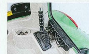
Fernbedienung fürs Zugmaul und super Kabeldurchführung sind Standard.
