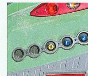
Die Knöpfe für Heben und Senken sitzen unlogisch – und für das Hydraulikventil fehlen sie rechts nach wie vor.
