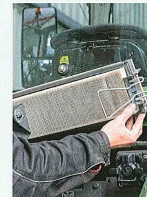
Mit Anbaugerät ist das Kabinenluftfilter in der Rückwand noch schlechter zugänglich.
