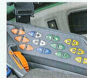
Bei 24 gleichförmigen Folientastern fällt die schnelle Orientierung schwer.
