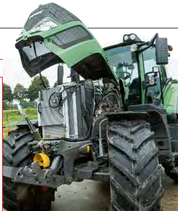
Der Sechszylinder von Deutz mit 6,1 l Hubraum erfüllt die Abgasstufe IV (Tier 4 f). Entsprechend ist der Motor vor lauter Nebenaggregaten kaum zu sehen. Fotos: Tovornik, Wilmer
