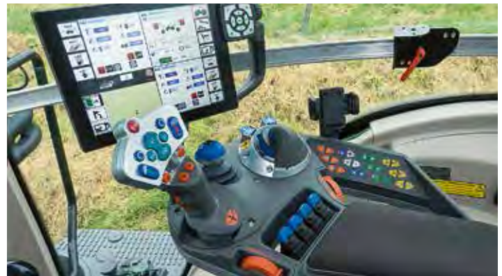
Im Armaturenbrett ist die AdBlue-Anzeige jetzt da, wo die Hydraulikölanzeige war. Die Bedienung von Licht und Lüftung sitzt nach wie vor auch hier vorne auf der Armaturenkonsolle.
