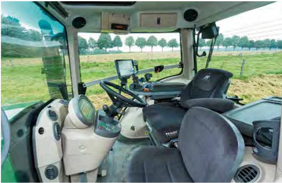
Die Kabine ist hell und komfortabel, mit 77 dB(A) aber noch nicht beispielhaft leise.
