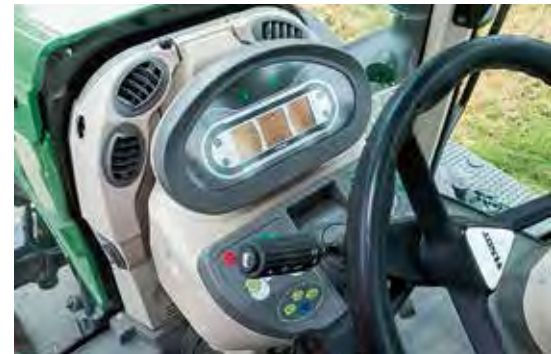
Im Armaturenbrett ist die AdBlue-Anzeige jetzt da, wo die Hydraulikölanzeige war. Die Bedienung von Licht und Lüftung sitzt nach wie vor auch hier vorne auf der Armaturenkonsolle.
