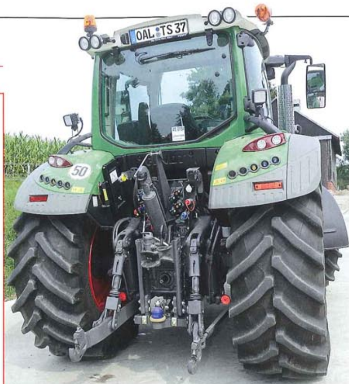
Das Heck ist sehr aufgeräumt, die Seitenstabilisatoren nach wie vor beispielhaft. 6,6 t Hubkraft reichen aus, und mit der großen Ölpumpe stimmt auch die Hydraulikleistung. Eine externe Ventilbedienung rechts fehlt noch.
