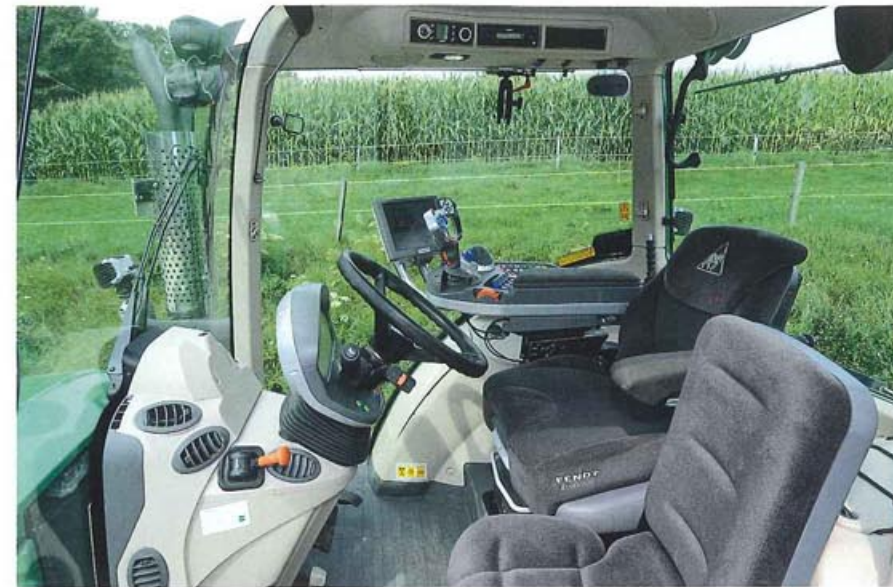
Mit 74 dB(A) unter Last ist die Geräuschbelastung okay. Platzangebot und Komfort sind super!
