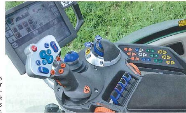
Das Armaturenbrett ist informativ und übersichtlich. Und auch wenn das Panel für die Schaltung des Arbeitslichtes teilweise vom Lenkrad verdeckt wird, ist es sehr gut erreichbar.
