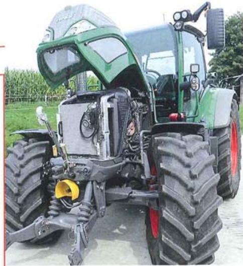
Der Deutz-Vierzylinder hatte eine sehr gute Leistungscharakteristik. Und im Zusammenspiel mit dem stufenlosen Getriebe stimmt auch der Verbrauch. Fotos: Tovornik
