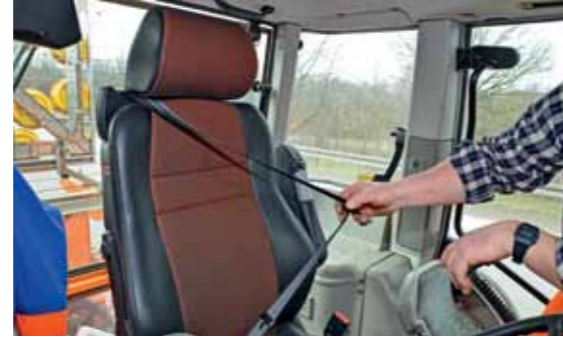
Der Dreipunktgurt und die Nackenstütze sorgen für mehr Sicherheit im Straßenverkehr.
