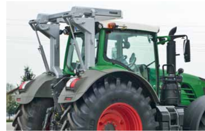
Der Überrollschutz ist für ein Maschinengesamtgewicht bis 22 Tonnen zugelassen
