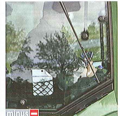
Nicht blickfrei: Der Wischermotor gehört in die Mitte oder nach links!
