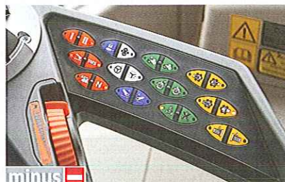
Nicht tastbar: Die identischen Folientaster in der Armlehne.
