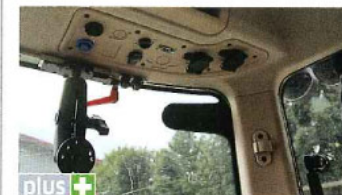
Vollständig: alle Anschlussdosen, ein Terminalhalter und die Kabelführung am Holm.
