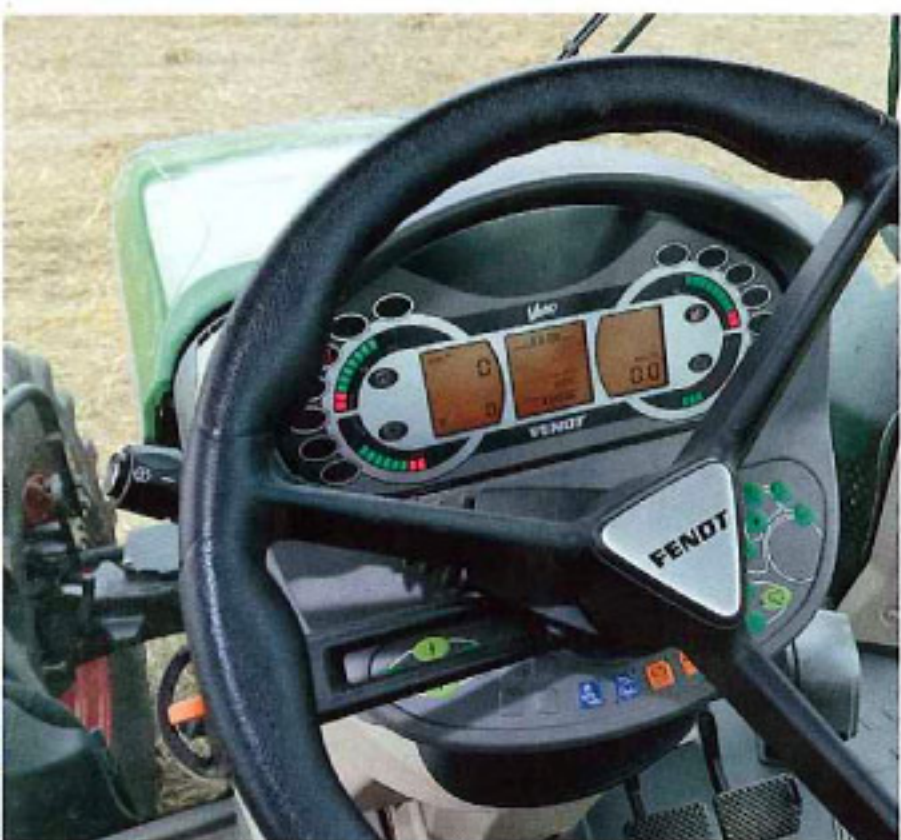
Die Anzeigen und die Schaltung der Arbeitsscheinwerfer sind übersichtlich. Der Blinkerrücksteller wurde verbessert und der (kleine) Wendeschalthebel sitzt näher am Lenkrad.
