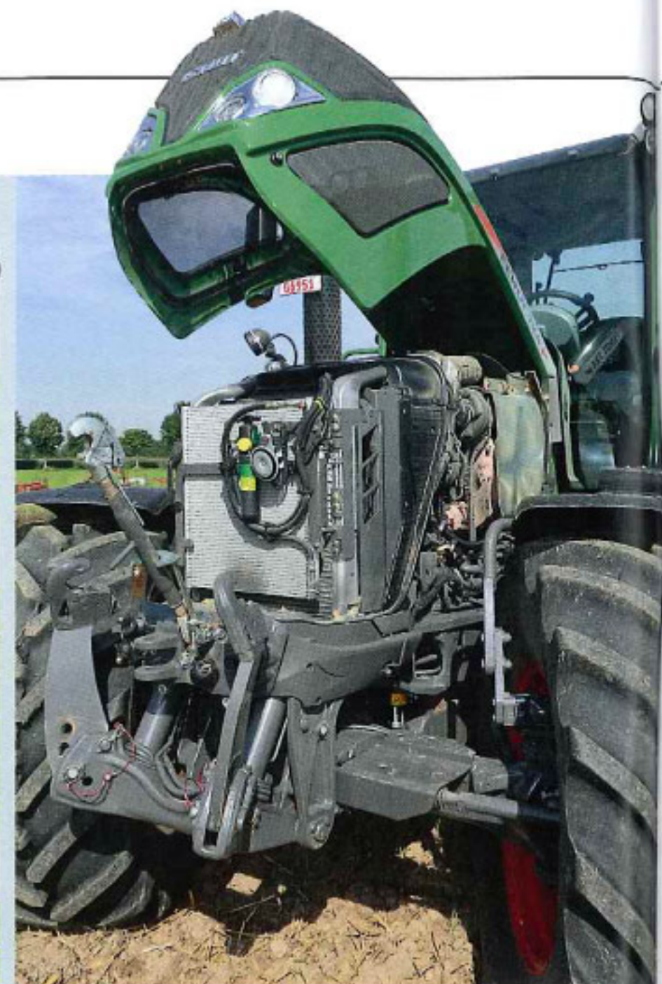
Der Deutz mit 6,1 l Hubraum brachte gute Leistungswerte und ist sparsam, man muss aber auch AdBlue tanken. Bis auf den Klimakondensator stehen die Kühler jetzt fest.
