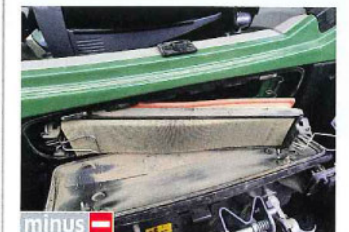
Vor allem bei angebautem Gerät ist das Kabinenluftfilter in der Rückwand nur aus der Kabine gut zugänglich.
