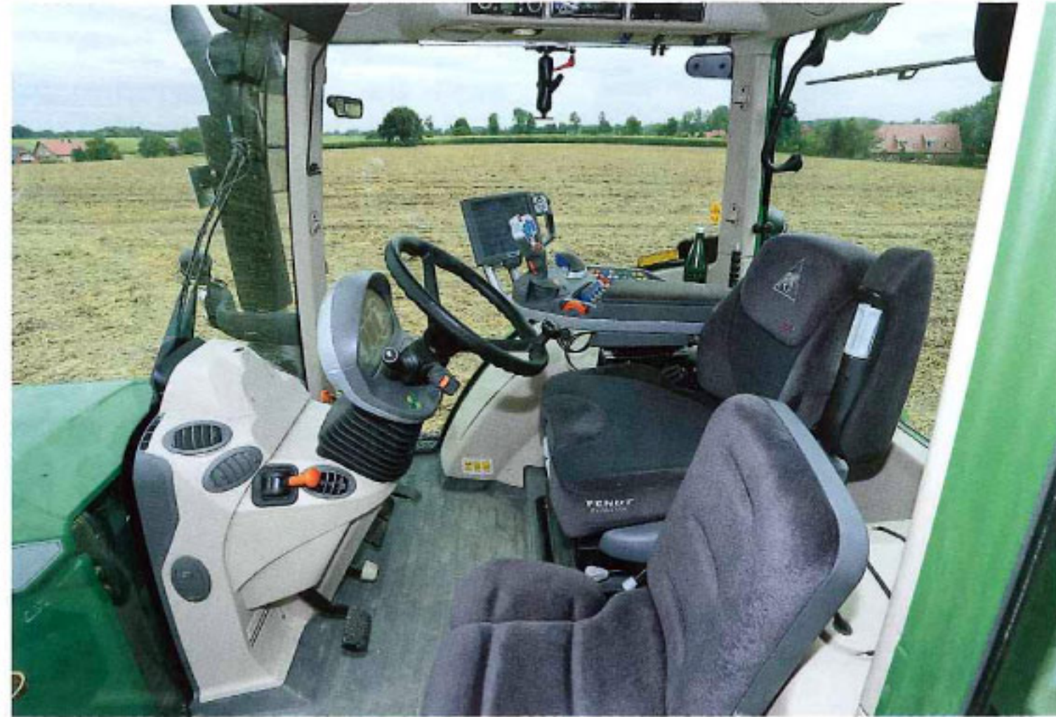
Die neue Kabine mit der (aufpreispflichtigen) Vollfederung bietet einen sehr guten Fahrkomfort und eine gute Sicht. 74,6 dB(A) unter Last sind kein Rekord, aber okay. Lenkrad samt Armaturenbrett werden mit dem mittleren Pedal entriegelt.
