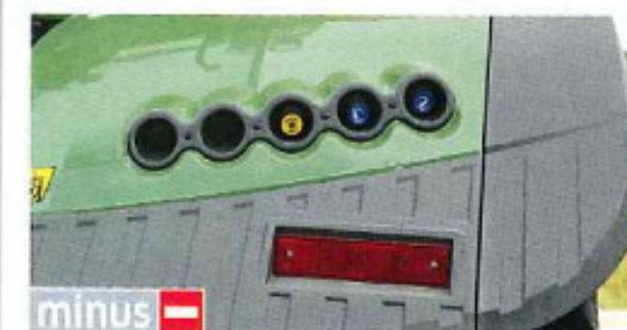
Die Knöpfe für die externe Ventilbedienung rechts sollten in dieser Liga nicht fehlen.
