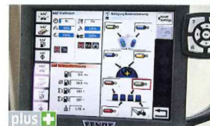
Beispielhaft und kinderleicht sind die Möglichkeiten bei der Zuordnung von Ventilen und Fronthubwerk zu den Bedienelementen.
