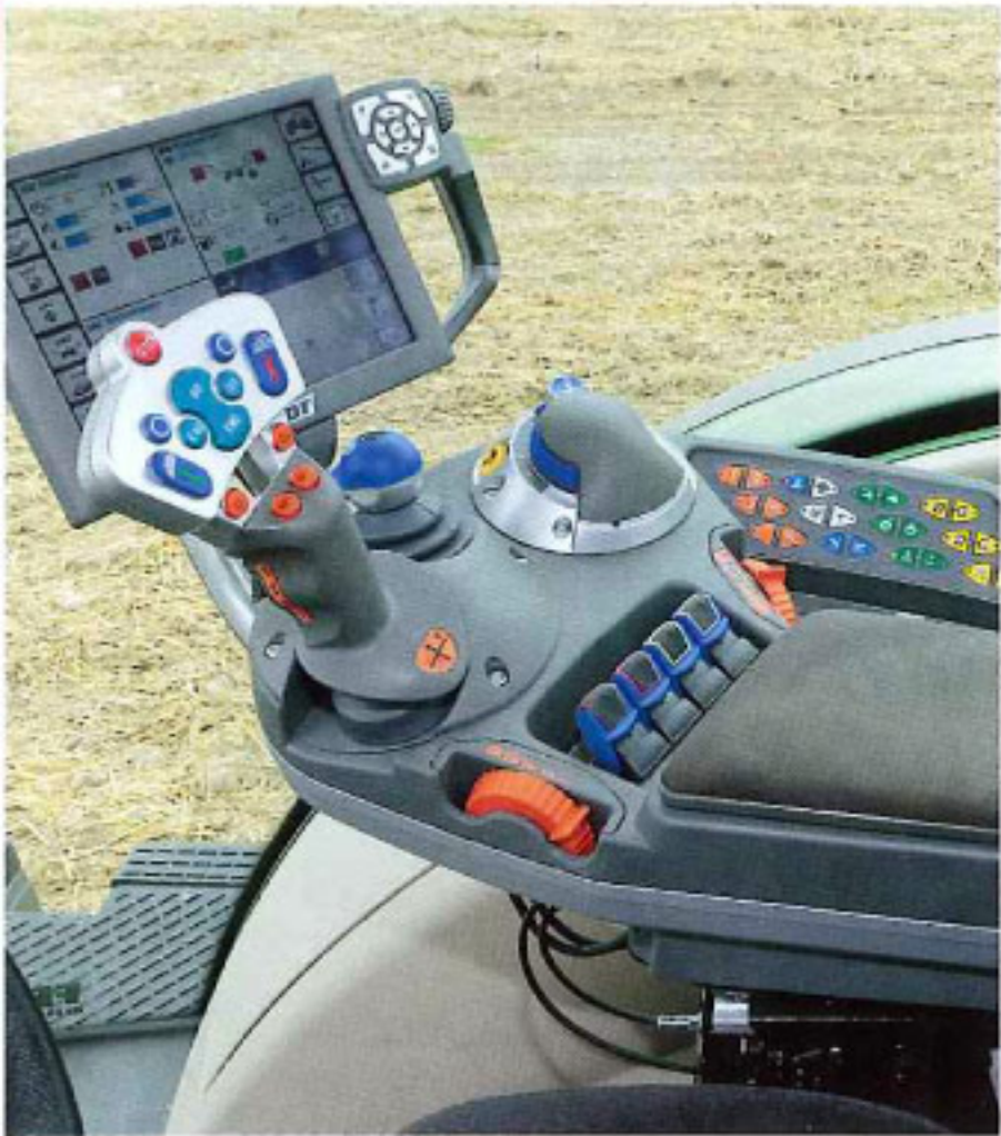
Fahrhebel und Monitor sind beispielhaft, lediglich die gleichförmigen Taster auf der Armlehne sind nicht „blind“ zu unterscheiden.
