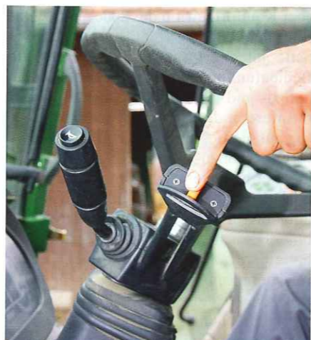
Mit dem Reversierhebel kann per Knopfdruck die Fahrtrichtung geändert werden.
