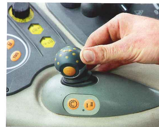
Mit dem Variostick kann man beschleunigen oder verzögern und auch die Fahrtrichtung ändern.
