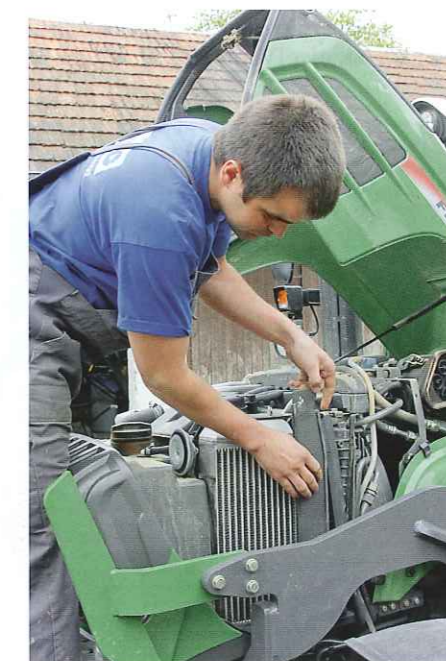
Blick in den extrem kompakt verbauten Motorbereich: Für Wartungszwecke gut zugänglich.
