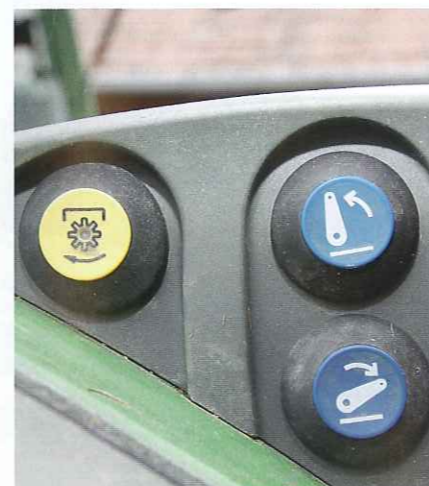
Die farbliche Kennzeichnung findet auch am Kotflügel seine Fortsetzung: Gelb für Zapfwelle, Blau für Hubwerk.
