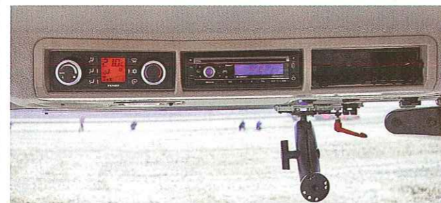
Pkw-Komfort: Klimautomatik und Einbauschächte für Funk und Radio. Darunter der (verschiebbare) Halter für Geräteterminals. Oben gibt es aber leider keine Luftdüsen.
