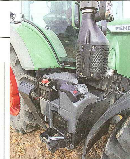
Unten in dem dicken Auspuff sitzt der SCR-Kat. Die Werkzeugkiste gleicht noch immer eher einem „Damentäschchen“. Der Aufstieg rechts ist senkrecht.
