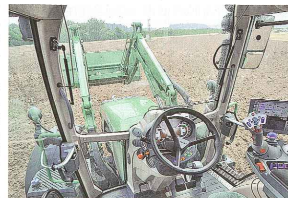
Die hoch gezogene Scheibe bietet eine sehr gute Sicht und ist – wie die rechte Tür – serienmäßig aufstellbar. Das Armaturenbrett schwenkt jetzt mit dem Lenkrad, und der Handbremshebel sitzt auch vorne.
