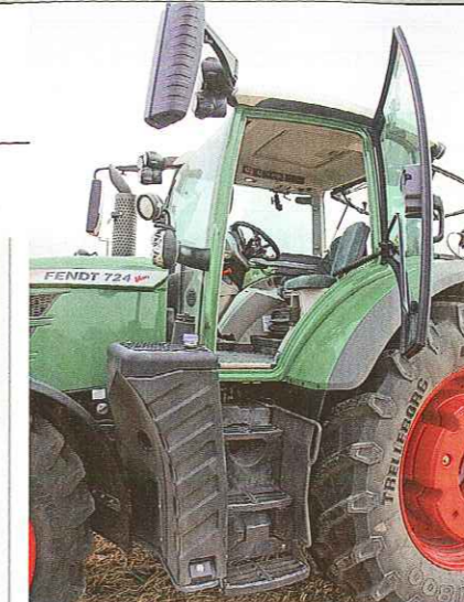
Der Dieseltank fasst ordentliche 400 l, der AdBlue-Tank 38 l. Der Aufstieg in die neue Kabine ist geräumig und hat jetzt sogar eine Beleuchtung.
