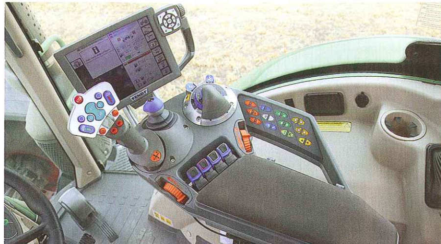
Die Bedienarmlehne mit dem großen Multifunktionsgriff und dem 10,7-Zoll-Touchscreen mit zusätzlichen Bedientasten ist von der neuen 800er Serie bekannt. Hier gibt es nicht mehr viel zu meckern.
