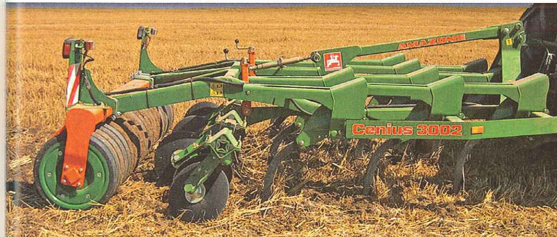
Cenius Super mit 3D-Zinken: 500 kg Überlastsicherung für Flächen mit hohem Steinbesatz
