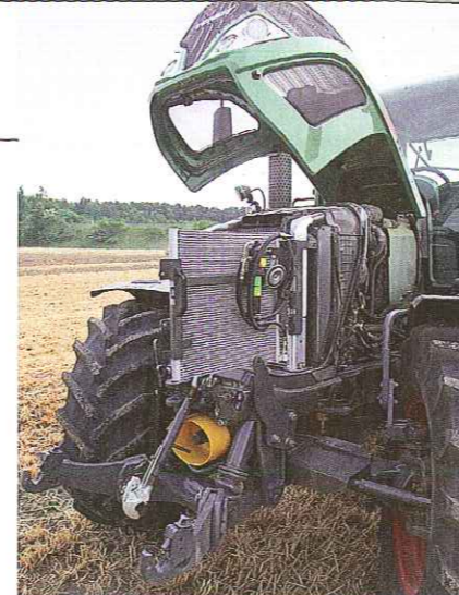
Motorhaube und Kühler wurden komplett neu gestaltet, bekannt ist dagegen der Sechszylinder von Deutz mit 6 l Hubraum, der im Topmodell 724 Vario 162 kW/220 PS leistet.
