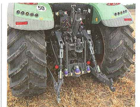
Die Hubkraft gibt Fendt mit 9,5 t an, und es gibt bis zu 7 Ventile (5 hinten, 2 vorne). Die Anhängerkupplung hat jetzt auch das breite Flanschmaß mit 2 t Stützlast. Der Kabinenfilter sitzt in der Rückwand, die LED-Rückleuchten sind Serie.
