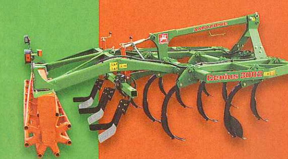
Cenius Super mit 3D-Zinken: 500 kg Überlastsicherung für Flächen mit hohem Steinbesatz
