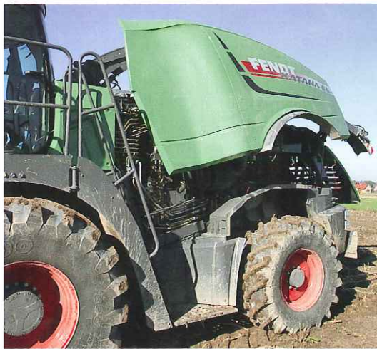
Die Seitenklappen werden über ein Parallelführungsgestänge geöffnet. Das bedeutet eine gute Zugänglichkeit...
