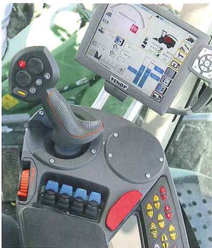
Die Armlehne samt Monitor stammt vom Schlepper, der Fahrhebel ist komplett neu.
