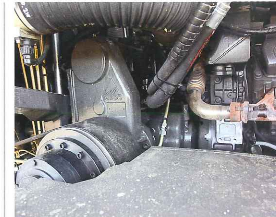
Vom längs eingebauten Motor geht es über ein nicht alltägliches Winkelgetriebe zum Antrieb des Häckselaggregates per Verbundriemen.
