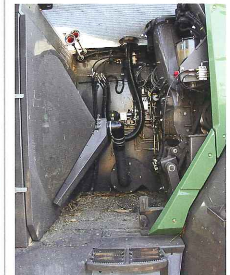
Dank großer Wartungsplattform sind Körnerprozessor, Wurfgebläse und Kühler gut zugänglich.
