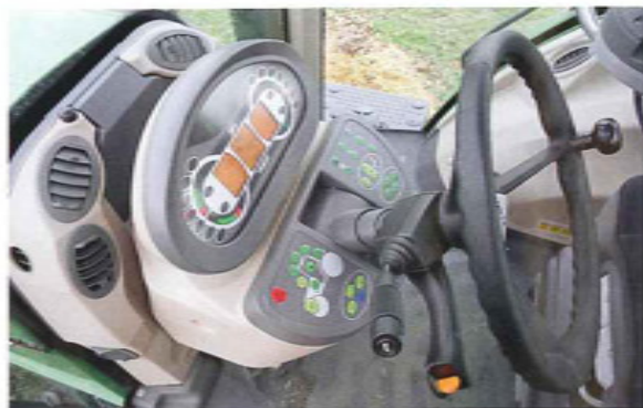
Das komplette Licht- und Lüftungs-Management sitzt im Armaturenbrett. Ab Werk gibt es sogar einen integrierten Lenkfix in dem griffigen Lenkrad.
