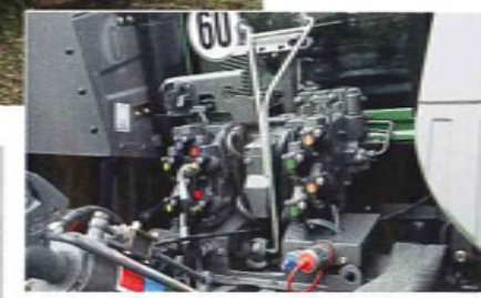
Die Anordnung, Beschriftung und Funktion der Ölschlüsse ist sehr gut. Bis zu 8 Ventile sind insgesamt möglich, 6 davon im Heck. Wahlweise eins mit 140 l/min Durchfluss.
