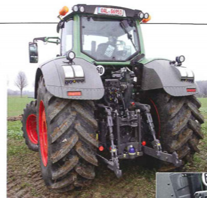
Die EHR arbeitet doppelwirkend und die Hubkraft reicht immer aus. Vorbildlich sind die externe Bedienung und die Gestänge-Stabilisatoren. Das Flanschmaß ist größer geworden, andere Kupplungen passen nicht mehr. Die LED-Rückleuchten kosten gut 600 Euro. Die Kameraposition ist variabel.
