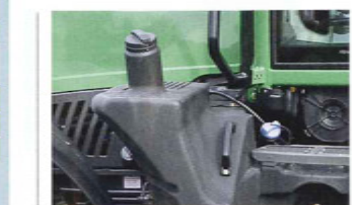
Der 6-l-Motor von Deutz erfüllt die Abgasstufe IIIb mit SCR-Kat und ist sehr sparsam. Neben dem 505-l-Dieseltank sitzt der Stutzen des 42-l-AdBlue-Tanks etwas versteckt.
