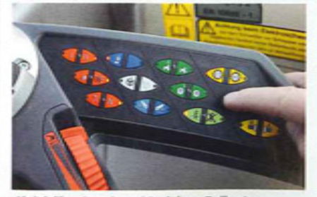
Gleichförmig: Die zahlreichen Folientaster sind nicht blind zu unterscheiden.
