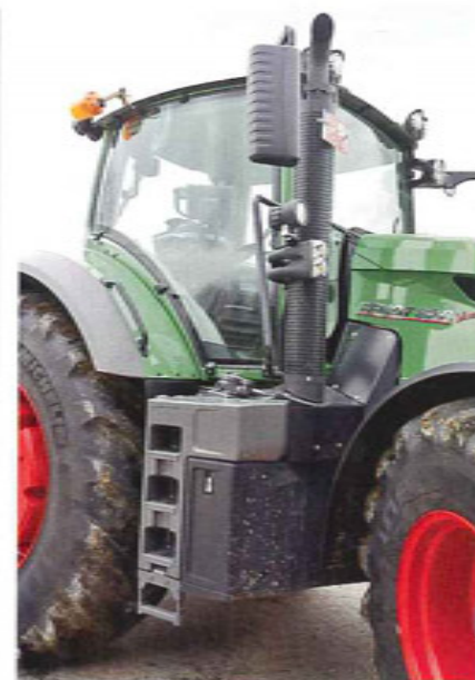
Genau wie die Frontscheibe geht die rechte Tür nicht auf. Der Aufstieg samt Griffen ist zum Reinigen der Fenster. Hinter der Abdeckung sitzt die Batterie.
