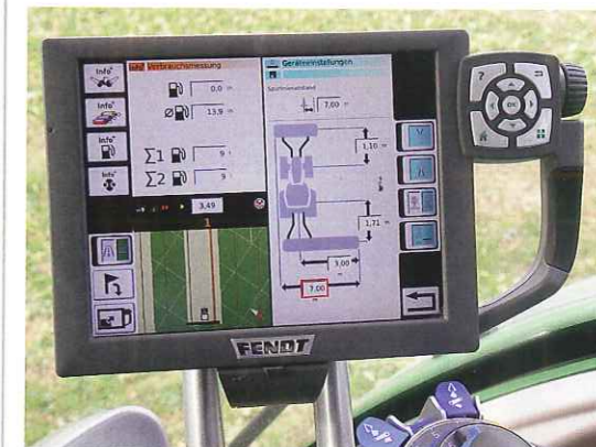
Vor Beginn der Arbeit muss man die Geräteeinstellungen festlegen. Zahlenwerte werden hier über den Drehknopf seitlich an der Daumentastatur verändert.
