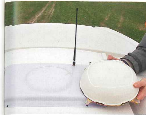
Empfänger, Antenne, Kreiselkompass und Neigungssensor hat Fendt unsichtbar und geschützt in der Dachluke untergebracht.
