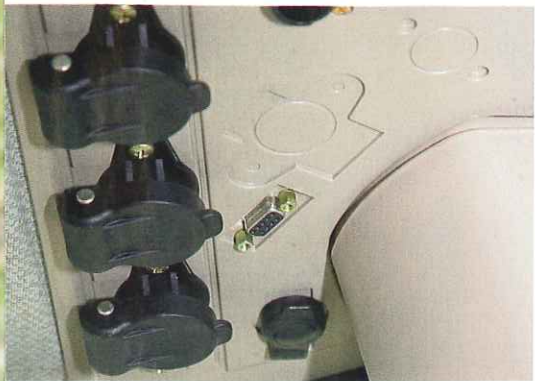
Über die serielle Schnittstelle im Kabinendach wird das GPS-Signal auch an externe Bediencomputer ausgegeben, z. B. für eine automatische Teilbreitenschaltung.
