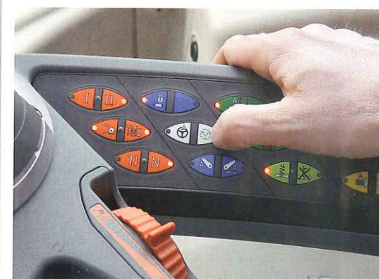
Über die weißen Tasten in der Bedienkonsole wird die automatische Lenkung voraktiviert und eingeschaltet.
