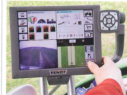
Der Bildschirm ist in vier Fenster unterteilt. Was Sie dort sehen wollen, können Sie selbst einstellen. Die Lenkung lässt sich jeder Zeit auf Vollbildschirm zoomen.
