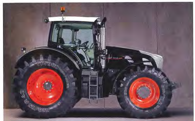
„Black Beauty“: Fendt 936 Vario, vorgestellt auf der Agritechnica 2007 Trelleborg TM900 HP 710/75R42 auf der Hinterachse
