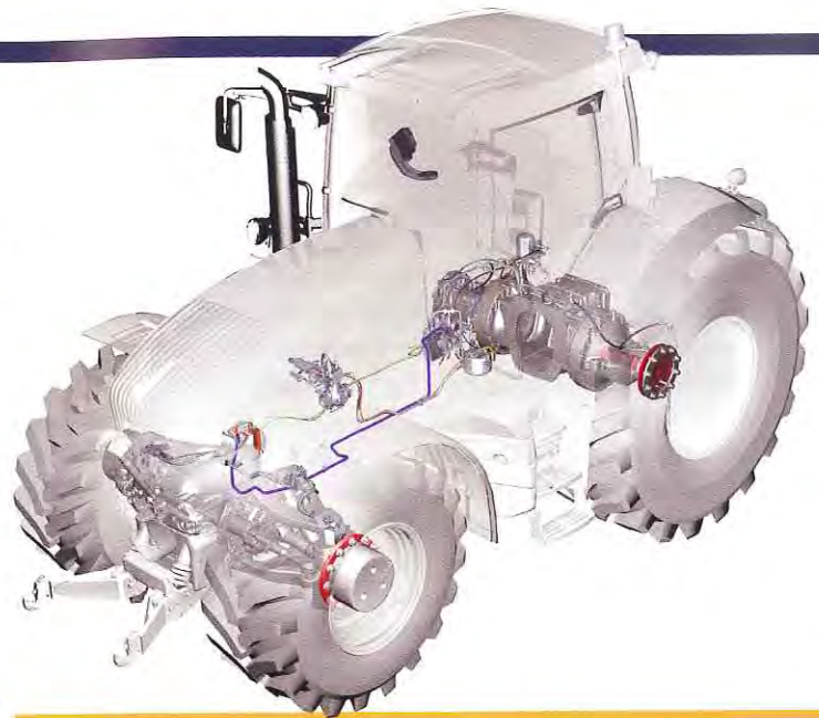
An einer Reifendruckregelanlage führt nach Meinung der Fendt-Ingenieure kein Weg vorbei – mit keiner anderen Technologie könne man ein zusätzliches Leistungspotenzial von im Extremfall bis zu 20 Prozent realisieren.
