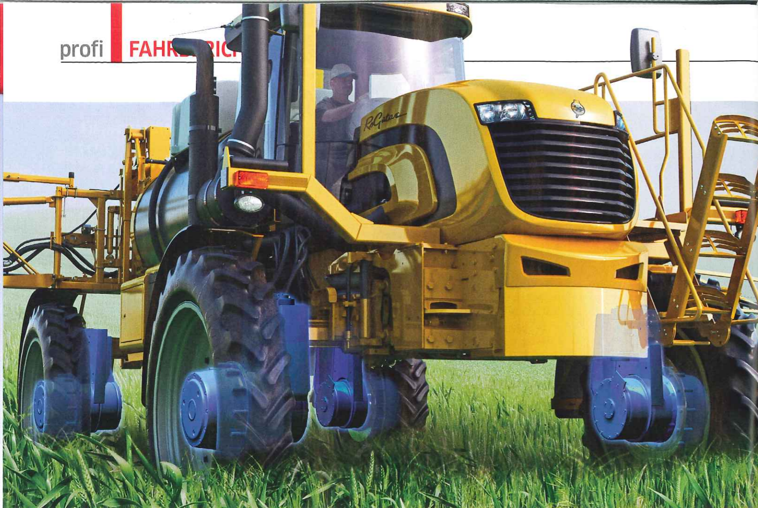
Die vier Radmotoren mit je 84 kW Antriebsleistung hat unser Grafiker blau gefärbt und in dieses Bild montiert. Illustration: Esser
