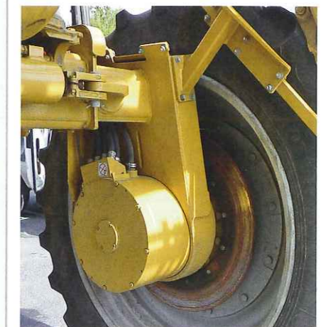
Die Bremsen sind im Prototyp noch sehr groß dimensioniert.
