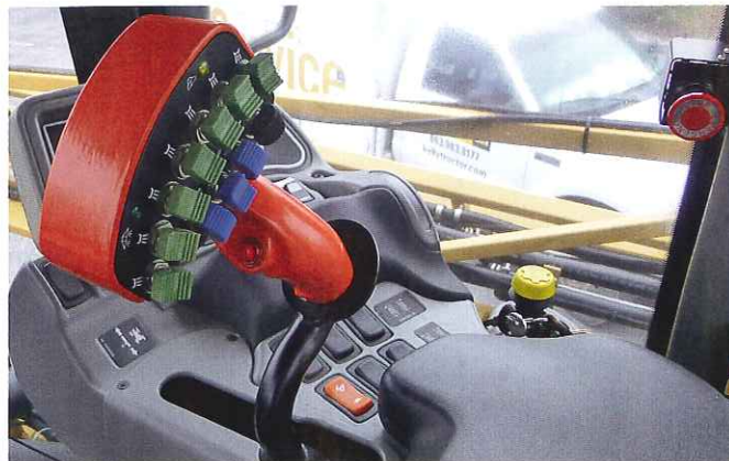
Der Fahrhebel ist im Prototyp noch unverändert wie beim Hydrostaten und etwas grob für die feinfühligere elektrische Steuerung, auch dank des dicken Kopfes mit der Teilbreitenschaltung. Rechts im Bild der Knopf für den Notstop des Systems.
