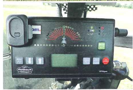
POSITION: GPS-Koordinaten + Arbeitsbreite = Autopilot.
