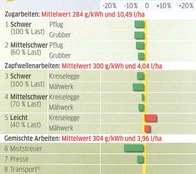
Der Motor erfüllt die Anforderungen der Abgasstufe III A und brachte sehr gute Werte – bis auf den Powermix...
