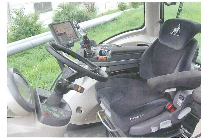
Auch in der Kabine wurde äußerlich wenig geändert, eine geänderte Überdruck-Lüftung erlaubt aber ein leichteres Schließen der Tür.
