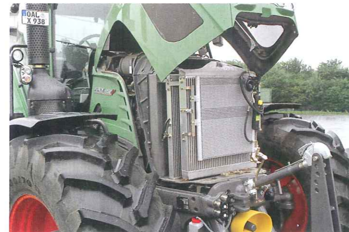
Der Deutz-Motor TCD 2013 hat statt knapp 7,2 l nun 7,8 l Hubraum und einen SCR-Katalysator, mit dem die Abgasvorschriften der Stufe III B erfüllt werden.
