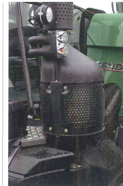
...und auf der rechten Seite am großen Topf im Auspuff („Gulasch-Kanone“), der den Katalysator beherbergt.
