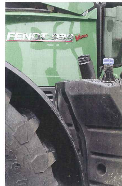
Zu erkennen ist der Neue auf der linken Schleppersseite am blauen zweiten Einfüllstutzen für die Harnstofflösung „AdBlue“.
