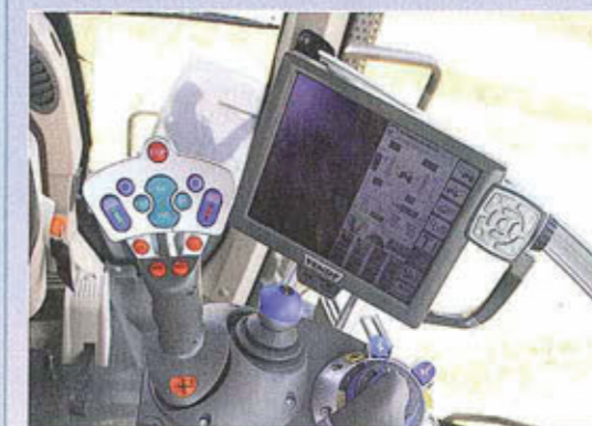
Die Bedienarmlehne mit dem großen Multifunktionsgriff ist von der 900er Serie bekannt. Ganz neu ist die Variotronic mit 10,7-Zoll-Touchscreen und zusätzlichen Bedientasten.
