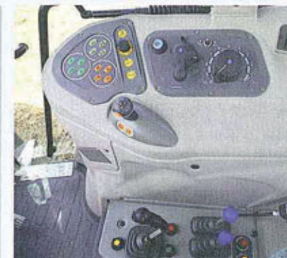
Das Vario-Getriebe kommt vom 300er, hat nur einen Fahrbereich und erlaubt 40 km/h. Die Bedienung erfolgt über den Vario-Stick statt über den Joystick, der in den Spezial-traktoren zu finden ist.
