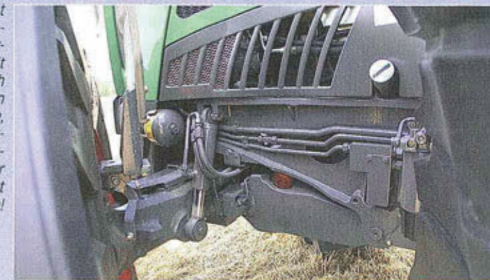
Der neue 800er hat auch einen Halbrahmen und eine Vorderachsfederung mit Längsschwinge. Doch die Zylinder gehen direkt auf die Achse, so ist eine Fahrwerkstabilisierung möglich. Denn auch der neue 800er fährt 60 km/h!
