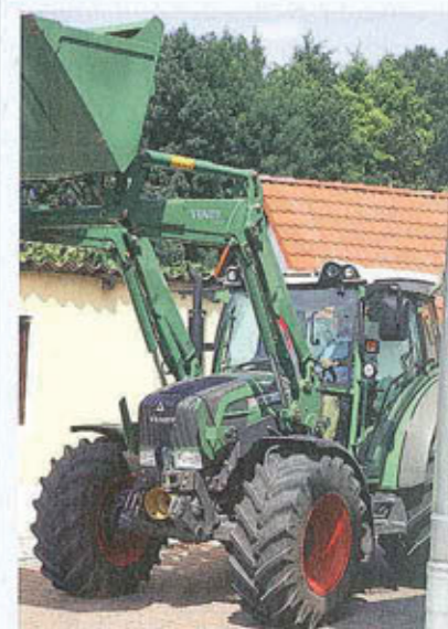
Der neue Frontlader 3 X 65 ist auf die 200er und 300er Vario-Schlepper abgestimmt.
