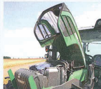
Vorne sitzt der Dieseltank, der samt Zusatz-tank 125 l fasst. Die Kühleransaugung erfolgt nur von den Seiten und von oben. Der Drei-zylinder kommt von Sisu und leistet im Vario 211 maximal 81 kW/110 PS.
