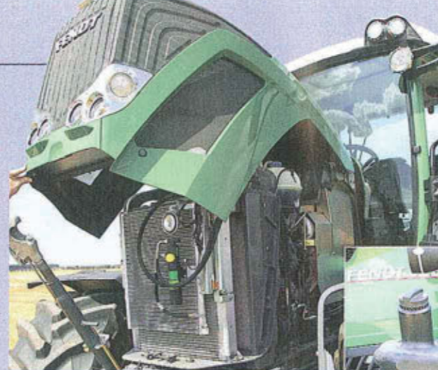
Der 6-l-Deutz-Motor hat einen SCR-Kat und erfüllt bereits die Abgasstufe 3b (Tier IV interim). Neben dem 500-l-Dieseltank sitzt der 42-l-AdBlue-Tank.
